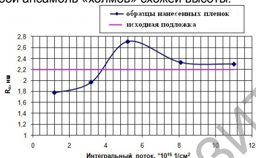
Рис. 2. Зависимость средней шероховатости поверхности образцов с нанесенными пленками Mo от интегрального потока ионов Mo^+ .
