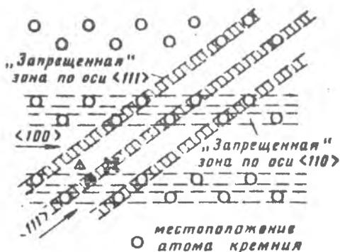
Рис. 15. Плоскость кремния (110), зондируемая вдоль осей (110) и (111). Темный кружок соответствует положению замещения, крест — тетраэдрическому междуузельному положению и треугольник — другому междуузельному положению
