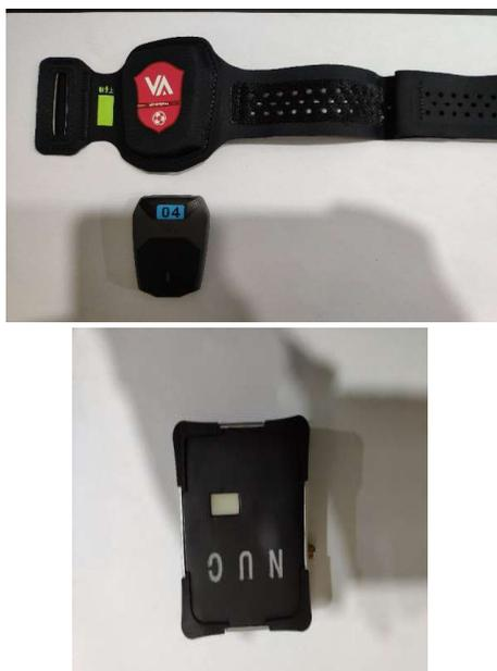
Рисунок 2 – Система для сбора информации: датчик T2 на поясе и датчик высоты позы S1
