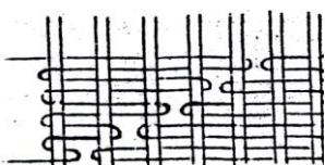
Рис. 2.9 Соединение за соседние нити основы со сдвигом
