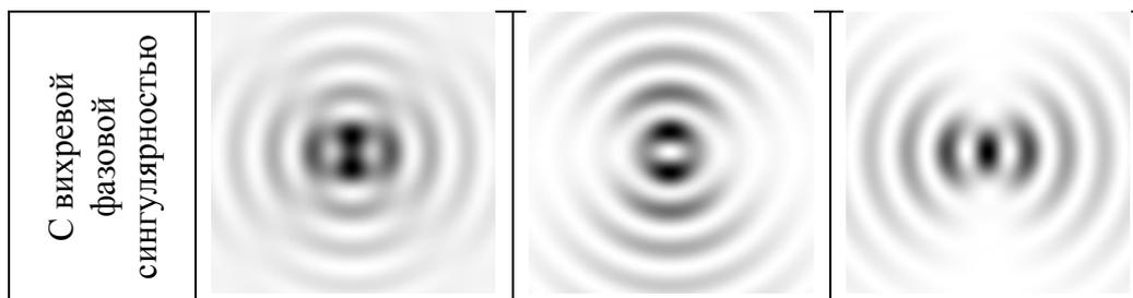
В табл. 3 и 4 приведены размеры фокального пятна по полуспаду интенсивности (FWHM) в плоскости максимальной интенсивности по оси распространения и радиус центрального пика ( $r_s$ ) для рассмотренных аксиконоподобных элементов.
