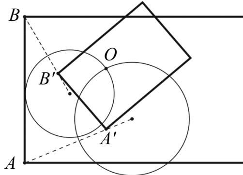
Рис. 2 – Построение неподвижной точки с помощью окружностей Аполлония
