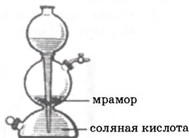
Рисунок 5 — Получение углекислого газа в аппарате Киппа
