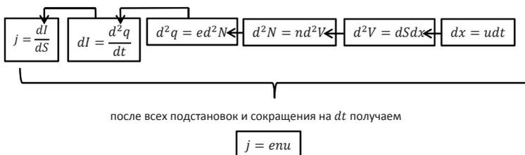
Рисунок 2. – Измененная схема вывода формулы для плотности тока
