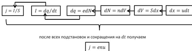
Рисунок 1. – Схема вывода формулы для плотности тока
