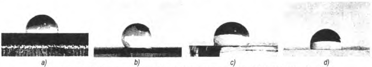
Рисунок 3 – Изображения капель воды на поверхности: а) образца № 1, б) образца № 2, с) образца № 3, d) образца № 4
