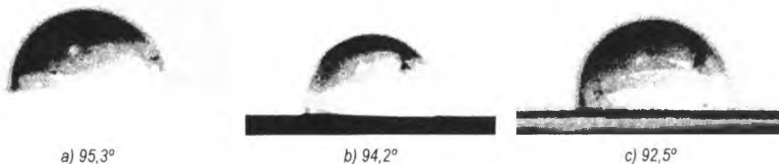
Рисунок 2 – Изображения капель воды на поверхности пленок CuIn_xGa_{1-x}Se_2 : а) образца 1; б) образца 2; в) образца 3
