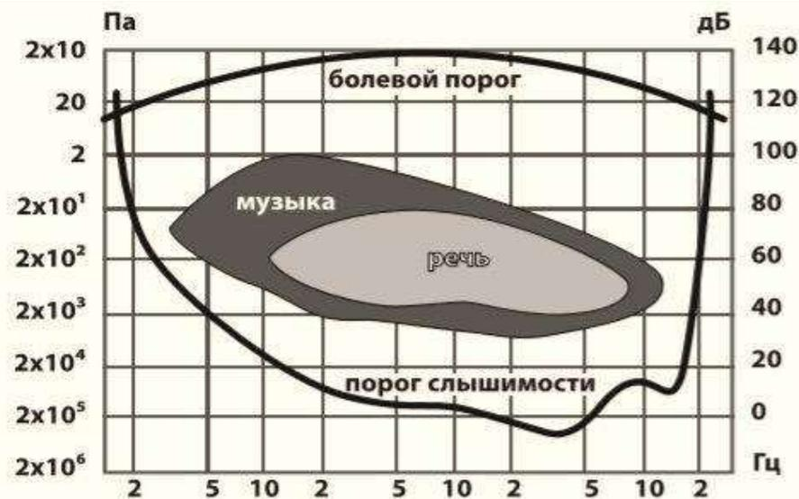
Рис. 3.3. Частотный и динамический диапазон слуха нормально слышащего человека (область слуховых ощущений)
