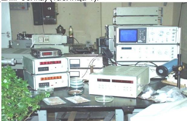
Фотография 1. Лабораторная установка для микроволновой предпосевной обработки семян.
