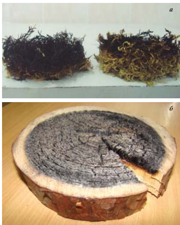
Рис. 6. Общий вид образцов мха ( D = 0,03 м, \rho = 50 кг/м 3 , w = 10 %) (а) после продолжительного теплового воздействия потока плотностью q = 10 кВт/м 2 (образец справа) и 15 кВт/м 2 (образец слева) в сравнении с образцом древесины сосны ( D = 0,035 м, \rho = 560 кг/м 3 , w = 40 %) при q = 20 кВт/м 2 (б)
