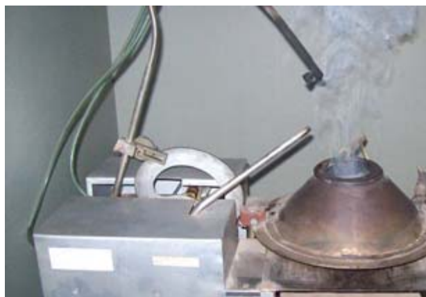
Рис. 1. Общий вид лабораторной установки для изучения температурно-временных параметров воздействия лучистого потока энергии на образцы напочвенного материала леса
