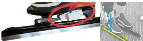
Рисунок 1 – Тензометрическая система регистрации вертикальной силы ( $F_z$ )
