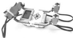
Рисунок 1 – Модель робота, собранная из Lego Mindstorms EV3
