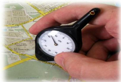
Наиболее точно расстояния на карте (как прямые, так и кривые линии) измеряют специальным инструментом – *курвиметром*.
