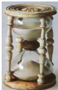
**Песочные часы** – два сосуда, соединенных узкой горловиной, через которую песок из верхнего сосуда перемещается в нижний. Песочные часы предназначены для измерения ограниченного отрезка времени – от нескольких секунд до нескольких часов или суток (в зависимости от размера часов).
