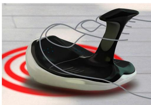
Рис. 2.17. Компьютерная ножная мышь
