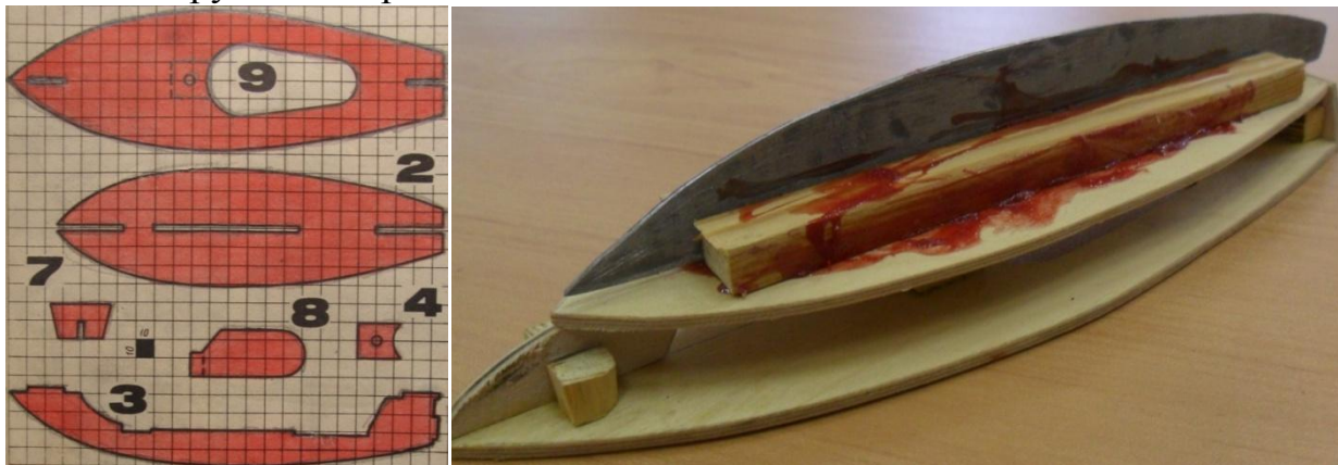
Рис. 7.2. Изготовление контурных деталей яхты
