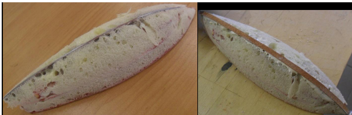
Рис. 7.5 Окончательная шлифовка и наклейка первой полосы шпона
