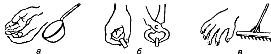
Рис. 60. Орудия труда, которые могли лучше и быстрее выполнять функции рук, прообразом, которых послужили пальцы и ладони рук: а — две сложенные ладони человек заменил черпаком; б — зажимающие предмет пальцы послужили прообразом клещей; в — растопыренные пальцы явились прообразом граблей
