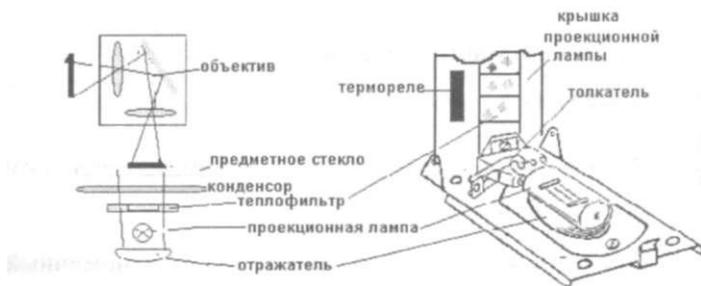
Рис. 119. Оптическая схема графопроектора (слева) и узел осветителя с проекционной лампой
