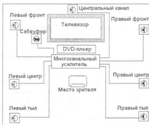
Рис. 57. Схема подключения DVD-плеера в составе домашнего театра по схеме 7+1
