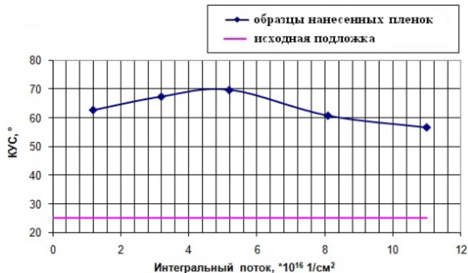
Рис. 4. Зависимость KUC поверхности образцов с нанесенными пленками Mo от интегрального потока ионов Mo^+
