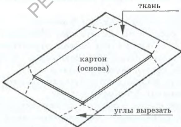
Рис. 2.28. Натягивание ткани на основу
