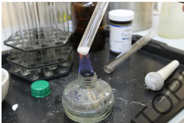
Рисунок 2. Нагревание анальгина в 8 мл разбавленной соляной кислоты.
