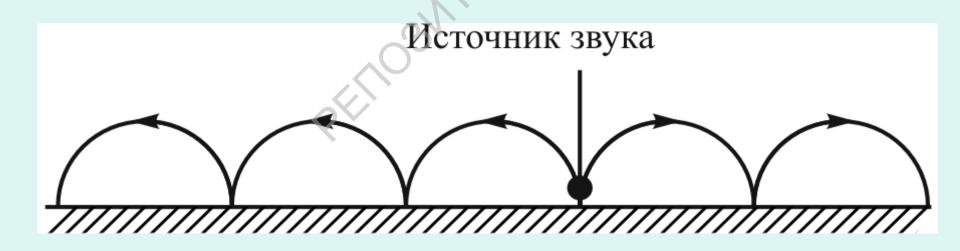
При наличии ветра его скорость и скорость звуковой волнь складываются.
