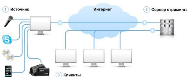
*Рис. 1. Схема создания трансляции с использованием стриминг технологий*
