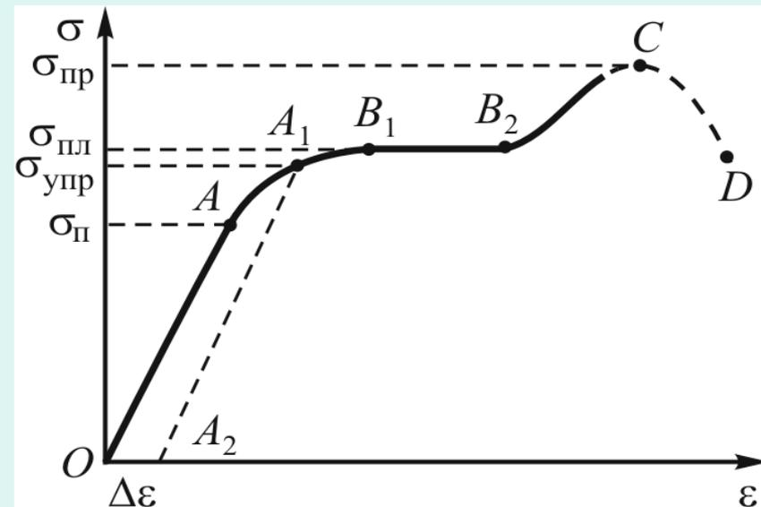
**Максимальное** напряжение  $\sigma_{\text{пр}}$ , возникающее в стержне до разрушения (точка С), называется **пределом прочности**.
