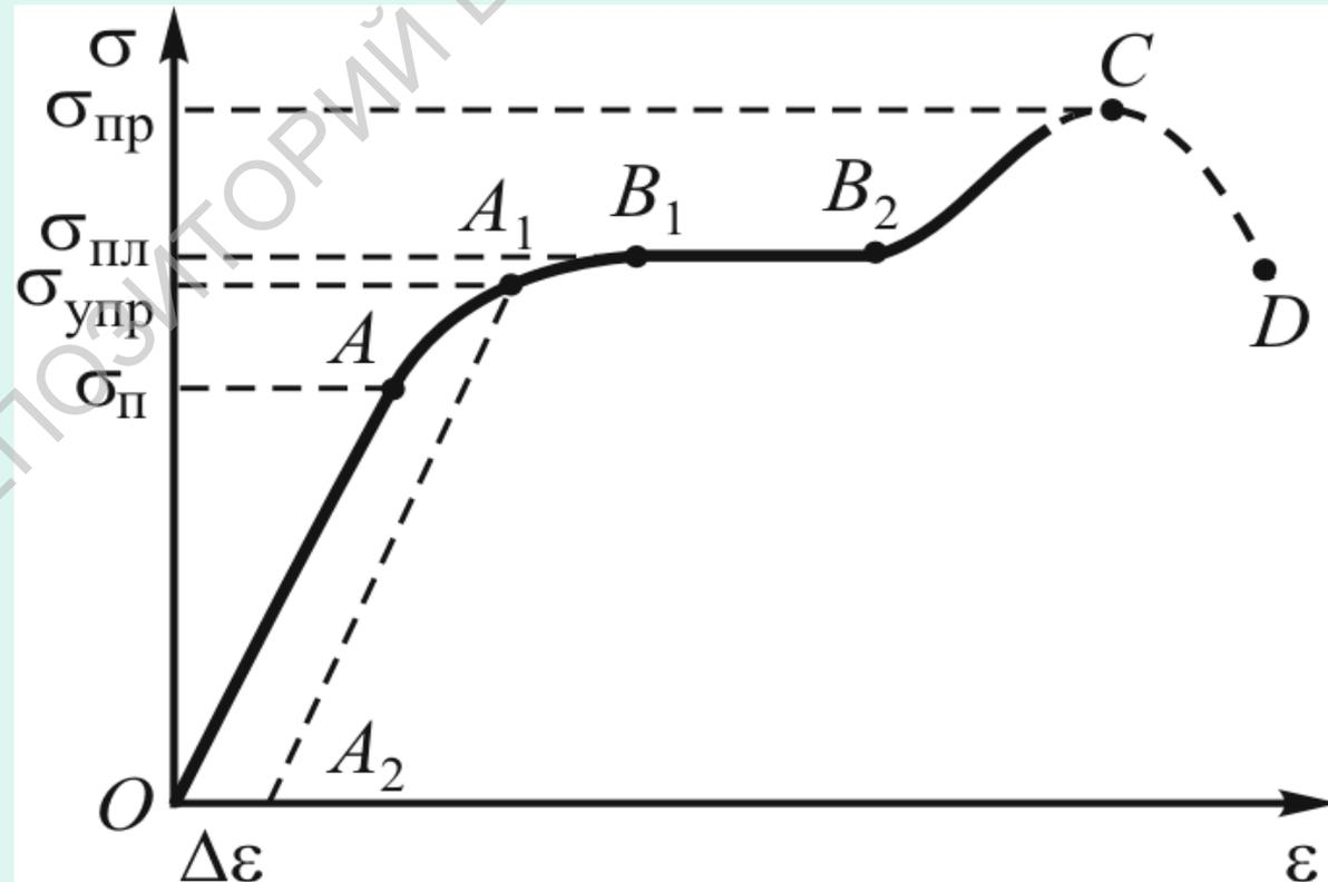
При напряжениях, более высоких, чем  $\sigma_{\text{упр}}$ , в стержне после прекращения действия внешней силы возникают остаточные или пластические деформации.
