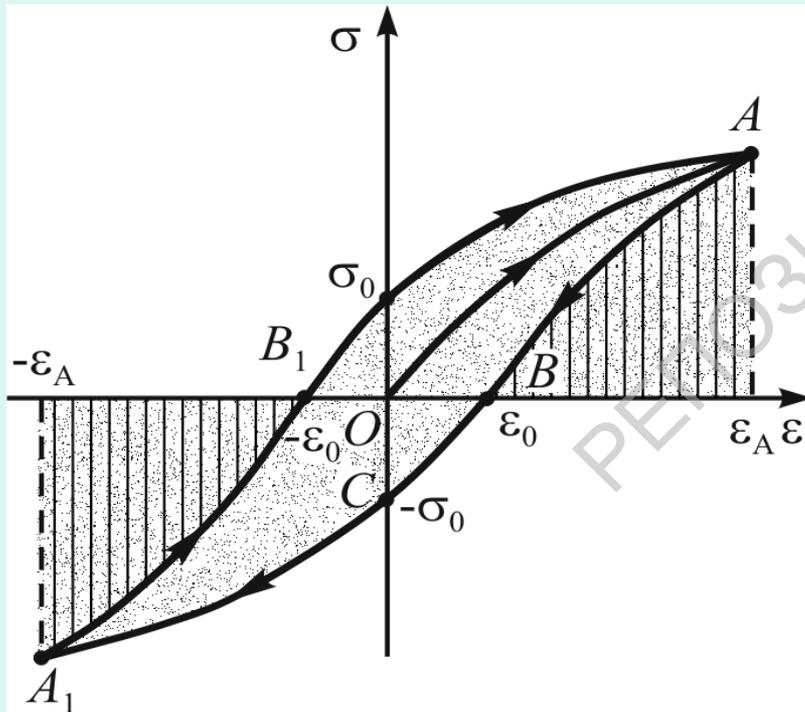
В результате в точке С относительная деформация станет равной нулю, но в стержне возникнет отрицательное по отношению к первоначальному напряжению  $-\sigma_0$ , которое определяется отрезком ОС.
