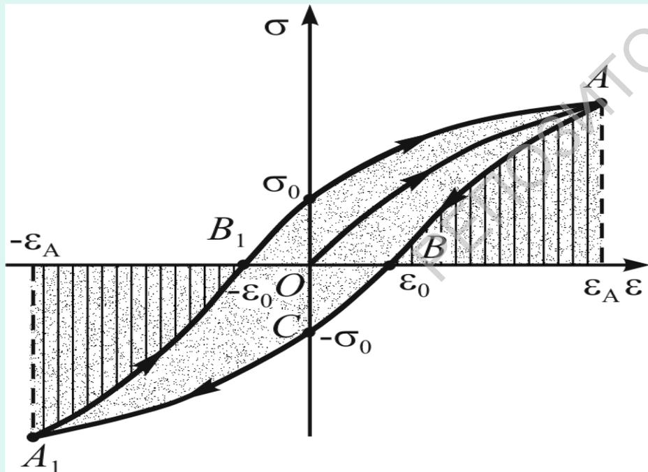
Таким образом, площадь петли упругого гистерезиса пропорциональна энергии, которая переходит во внутреннюю энергию (идет на нагревание тела) при каждом цикле деформации.
