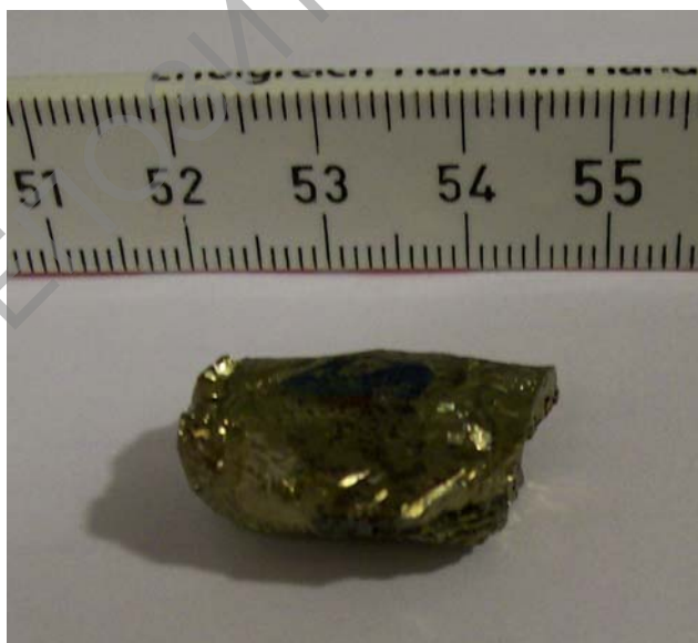
Рис. 1. Кристаллический слиток хайкоkitа \text{Cu}_4\text{Fe}_5\text{S}_8 , полученный двухзонным методом.
