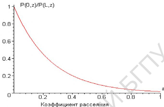
Рис. 1. Зависимость мощности обратно рассеянного сигнала от коэффициента рассеяния
