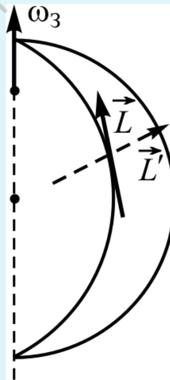
В результате ось гироскопа поворачивается так, чтобы угол между вектором момента импульса гироскопа  $\vec{L}$  и вектором угловой скорости Земли  $\vec{\omega}_3$  уменьшался.
