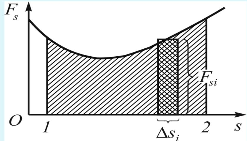
Работа на конечном участке движения 1—2 равна сумме элементарных работ
