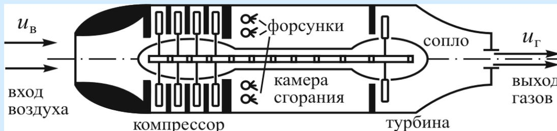
Продукты сгорания, проходя через сопло, вращают турбину, которая приводит в действие компрессор.
