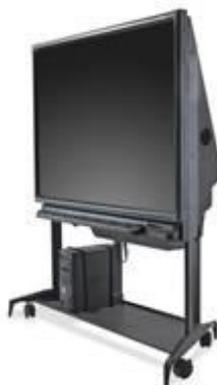
Существуют и интерактивные доски, представляющие собой сенсорную плазменную панель с чувствительной поверхностью, управлять которой можно не только специальным пером, но и пальцем или указкой. Здесь проектор отсутствует. Однако данная доска учитывает любое касание: как сознательное, так и случайное. Такие доски в учебном процессе обычно не используются, в том числе и по причине их очень высокой стоимости.
